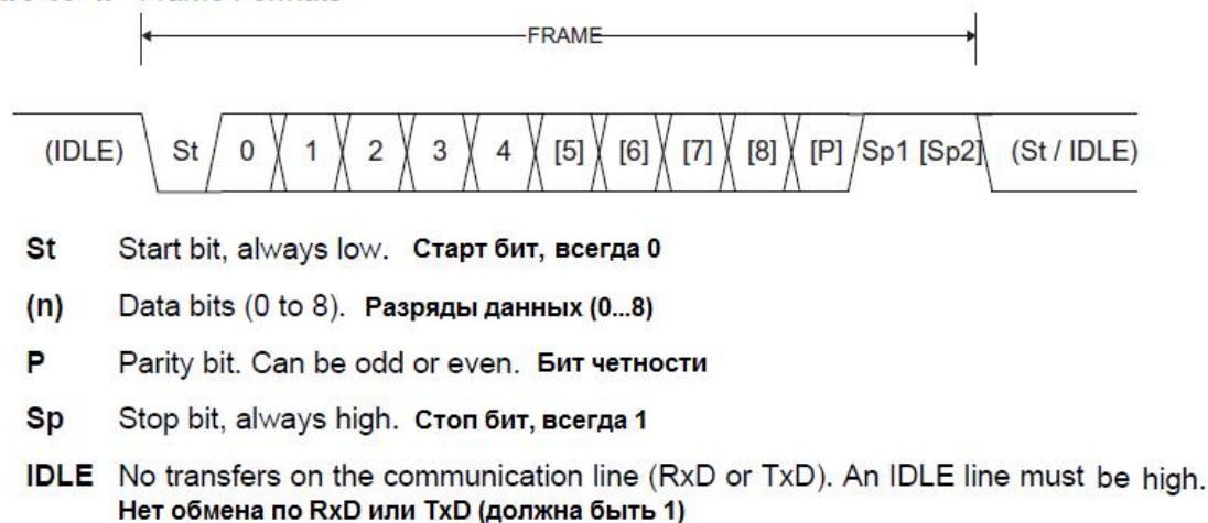
Рис. 23 — Формат кадра UART модуля
