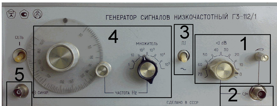
Рис. 4 Лицевая панель генератора прямоугольных импульсов ГЗ-112/1
