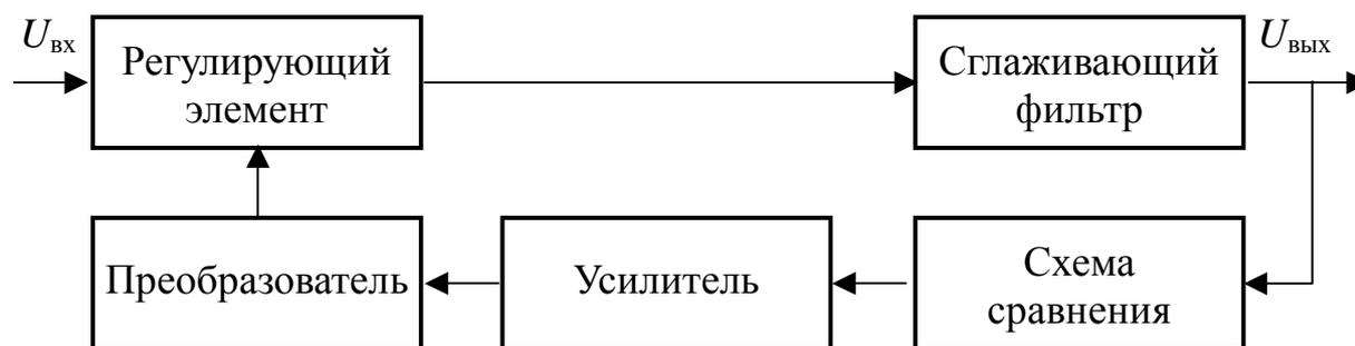
Рис. 4.25 – Структурная схема импульсного стабилизатора напряжения
